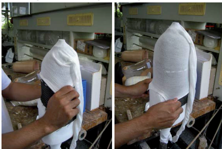
Figura 18 – Laminação (montagem das malhas)
