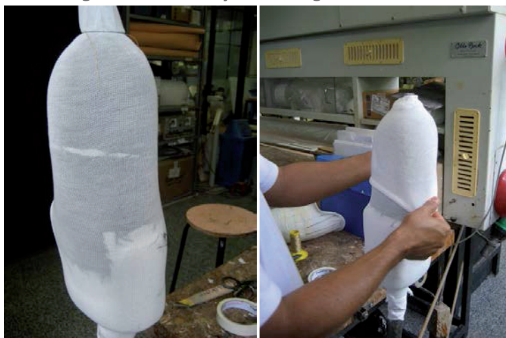
Figura 19 – Laminação (montagem das malhas)
